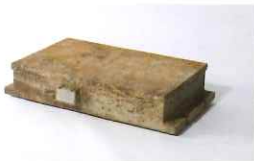
写真50 工作機械「マグネチックチャック」
